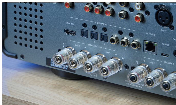
Prestige X430的喇叭线接口是每4个一组，共两组。每组接口已包含左右声道输出。别误会为每组是一个声道。它的数字接口包括HDMI ARC、光纤、同轴和USB Audio (USB-C)。另外，还提供蓝牙连接
