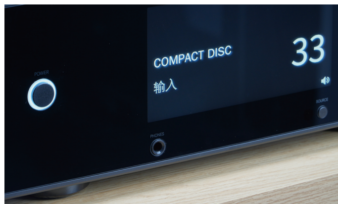
再看看前面板。屏幕下方分别是耳机接口和输入切换按键。开机键有环形背光，辨识度高
