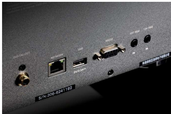
▲ 数字部分提供一组同轴数字输出，Ethernet网络接口主要用于网络控制以及获取专辑相关信息，此外还有一些控制接口
