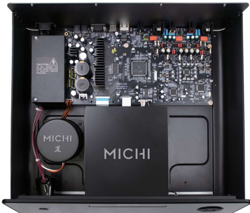
▲ Q430的内部非常规整，悬浮式转盘机构位于机身前方，电源部分针对数字部分和模拟部分才去不同的供电策略
