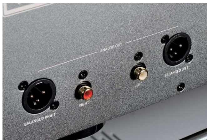
▲ Q430同时提供RCA单端和XLR平衡模拟输出
