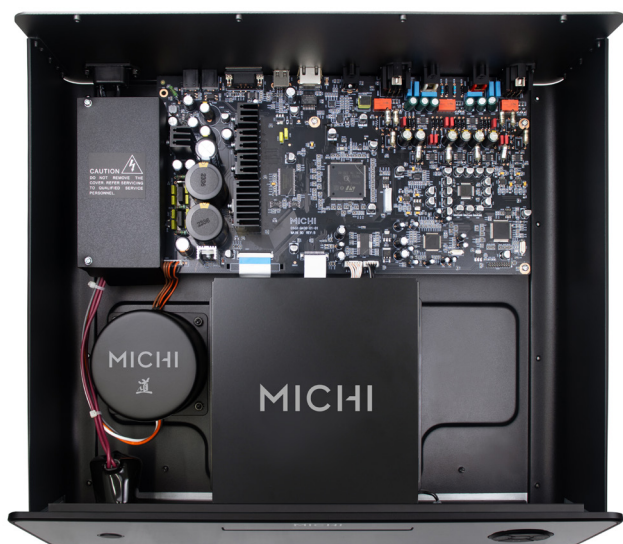
Q430内部一览, 可以清楚看到做了分区隔离设计, 左下角就是Rotel的超静音电源, DAC电路在右上角区域
