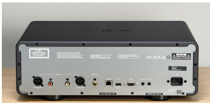
Q430背面接口一览, 提供了一组XLR平衡输出和RCA单端输出, 一组同轴数字输, 以及RS232和12V触发接口, 用于连接智能中控
