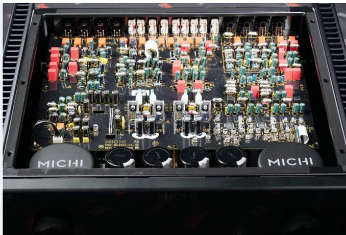
P5 Series 2前级的内部，双电源为左右声道独立供电，电路上还大量使用音响级电子零件
