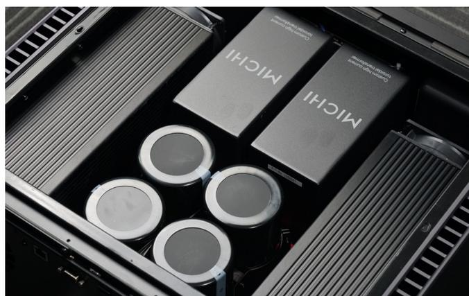
Michi M8的内部，有Michi字样的是封装的电源变压器，两边是功率放大部分，散热器是隧道式设计，每个散热器配置一把风扇将热量带走，四个圆柱形的元件就是滤波电容
