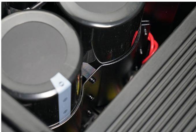
注意滤波电容的安装细节，这里使用一个金属支架对滤波电容进行加固处理，避免电容器受振动影响
