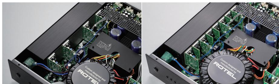
左图为C8，右图为C8+，由于输出功率不一样，C8为每声道70W（4欧姆），C8+为150W（4欧姆），它们俩的主体放大线路是一样的，只是因为功率输出的大小关系，功放电路的功率管数量和电源变压器的体积不一样
