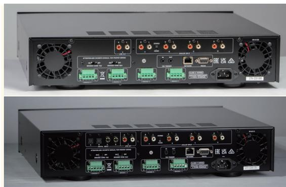
上图为C8，下为C8+。其中，C8+因为自带DAC，它的输入部分增加了数字输入接口，而且在散热设计上，C8/C8+都自带风扇辅助散热
