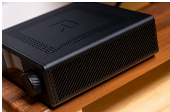
DX-5相比DX-3在顶部也增加了散热设计
