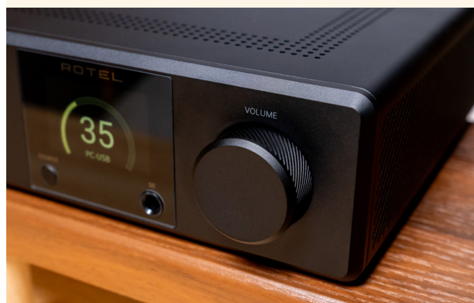
屏幕右侧的音量旋钮，有明显的机械顿感，阻尼手感舒适
