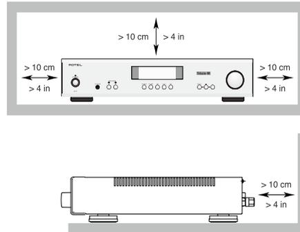
**ADVERTENCIA:** El conector del cable de alimentación del panel posterior hace las veces de dispositivo de desconexión de la red eléctrica. El aparato debe ubicarse en un área abierta que permita acceder fácilmente a dicho conector.
