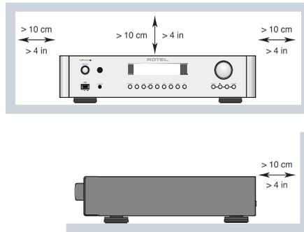
**ADVERTENCIA:** El conector del cable de alimentación del panel posterior hace las veces de dispositivo de desconexión de la red eléctrica. En consecuencia, el aparato debe ubicarse en un área abierta que permita acceder fácilmente a dicho conector.
